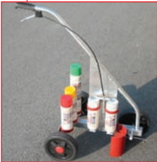
Carro de 3 ruedas que permite aplicar dos capas de pintura en una sola pasada
